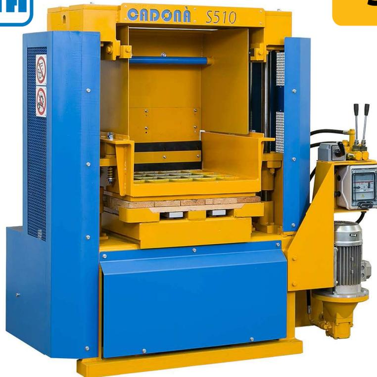
Petite machine de fabrication de blocs, simple d'utilisation, basique et robuste, destinée aux pavés et petites bordures de qualité, la S510 produit d'excellents blocs muraux.
